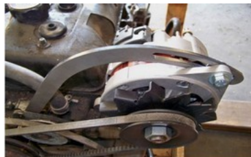
MP1240B Kit de montage alternateur livré avec plusieurs entretoises à utiliser suivant le type de poulies du moteur
